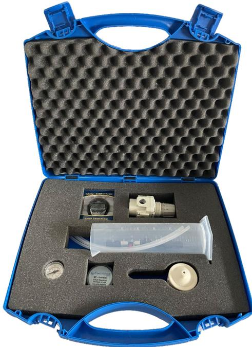
Per determinare la velocità con cui il particolato e le sostanze colloidali intasano la membrana, viene usato un metodo di misura largamente accettato chiamato Silt Density Index (SDI). Il test comprende un breve ciclo di filtrazione attraverso una membrana di microfiltrazione (MF) da 0.45 µm. Uno svantaggio del test SDI è il fatto che è difficile ottenere un valore SDI molto preciso utilizzando degli strumenti manuali. Le più importanti fonti di errori conosciute sono:
